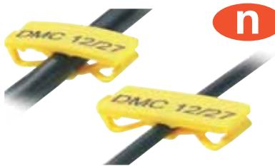
DMC 标记号用于电器设备和元件的标记，足够大的标记号面积 (12 x 27 mm) 足以记录及其功能等多种信息，通过一个简单的支持机构，可将其固定在导线和电缆上。DMC 标记号可固定在截面积为 0.5-10mm<sup>2</sup> 的导线上，采用 MultiCards 格式，可通过 MCP Plus, PrintJet, SMark, MC Mobile 打印机进行打印。
